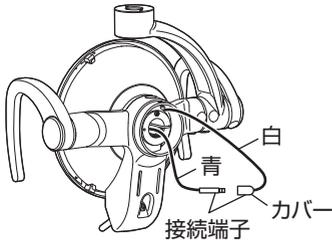
9 キャップを取り付け、ローレットビスを締めます。
