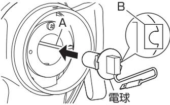
7 バルブ押さえバネを取り付けます。バルブ押さえバネを押して、しっかりと差し込みます。
