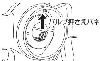
4 バルブ押さえバネを取り外します。バルブ押さえバネがかかっている部分を、イラストのように上方向に引き抜いて取り外します。
