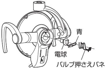
6 清潔なティッシュなどで新しい電球を持ち、A側にBを合わせて(切り欠き形状が丸)差し込みます。
