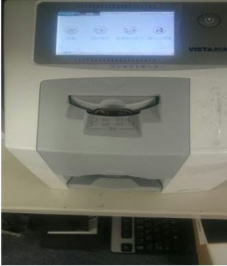
IPスキャン時、IPプレートが挿入口に詰まってしまった場合、主電源ボタンを長押しで主電源を切ります。
